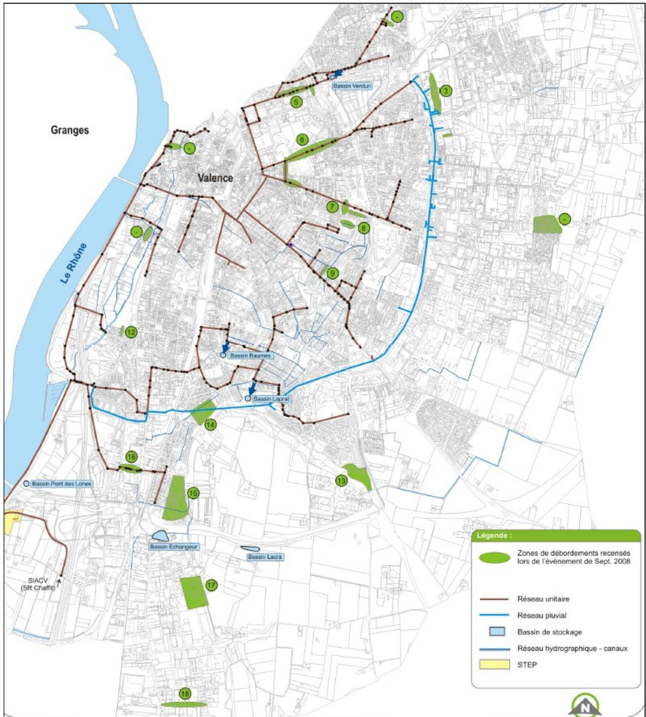
Figure 8-15 : localisation des dysfonctionnements hydrauliques. Source : SDA 2011
